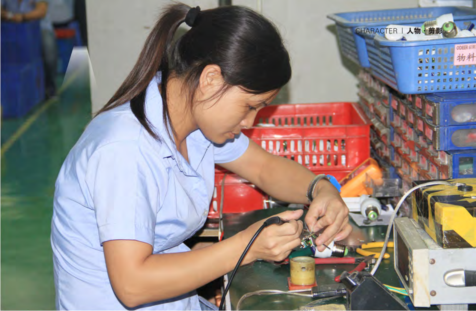
5. 秦义菊正在给BB9W的节能灯不良品换保险电阻。
